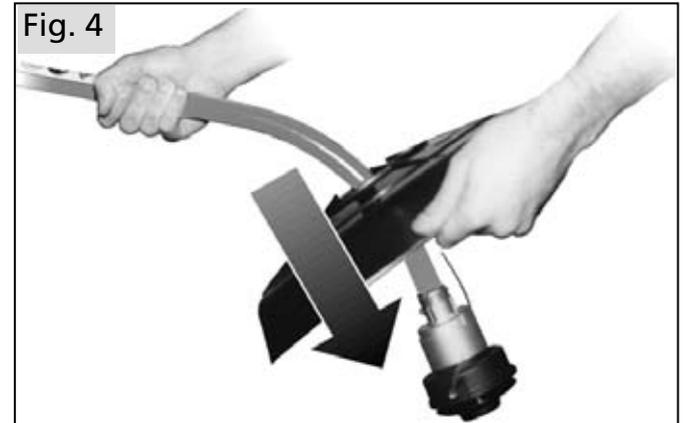
Den Schutz über das Schaftrohr von oben an die korrekte Position führen. Der Schutz muss zum Benutzer bei korrekter Arbeitshaltung gerichtet sein.
