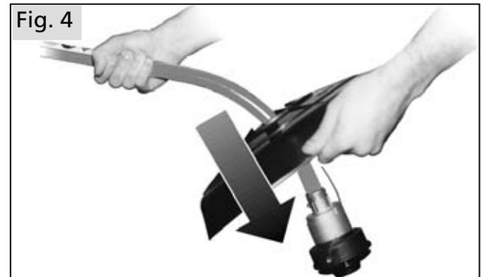
Coloque el protector desde arriba en la posición deseada sobre la barra. Para que la posición de trabajo sea correcta, el protector ha de estar orientado hacia el usuario.
