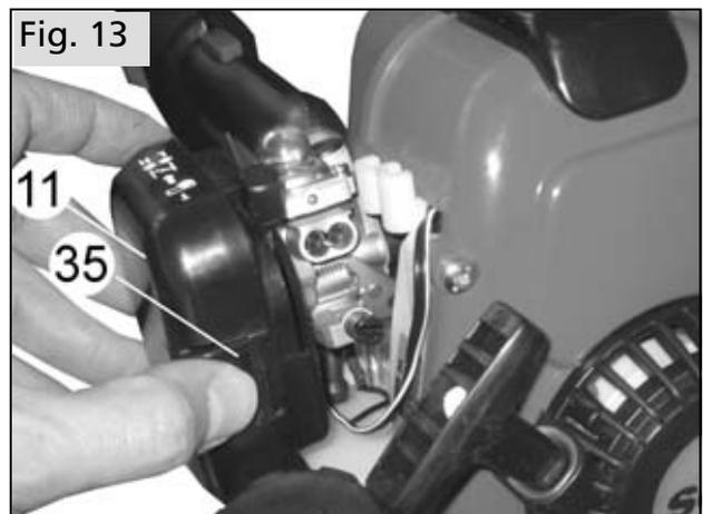
Antes de abrir el filtro del aire cierre la tapa del starter para que no entre suciedad en el carburador.
