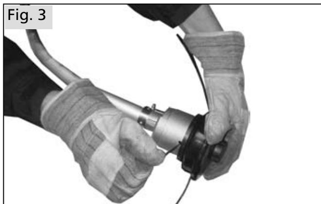
Bloquee el engranaje con la espiga (llave de tipo hexagonal). Acople el cabezal de hilo al engranaje girándolo en el sentido de las agujas del reloj.
