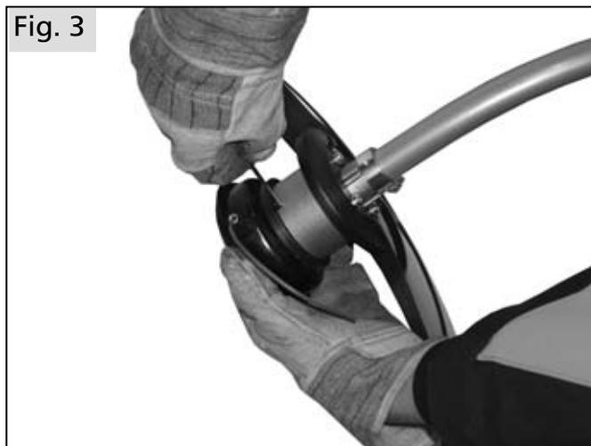
Mit dem Haltestift (Inbusschlüssel) die Antriebswelle blockieren. Den Fadenkopf im Uhrzeigersinn auf die Antriebswelle schrauben.
