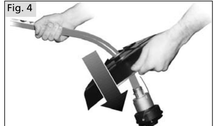
Den Schutz über das Schaftrohr von oben an die korrekte Position führen. Der Schutz muss zum Benutzer bei korrekter Arbeitshaltung gerichtet sein.
