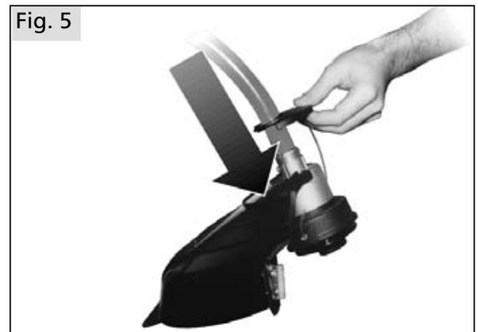
Das Befestigungsteil ebenfalls über das Schaftrohr an die korrekte Position führen, so dass der offene Teil des Kreises zum Benutzer gerichtet ist.
