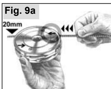
Schneidfäden in den Grundkörper des Schneidkopfes gemäß den Pfeilen auf dem Grundkörper einschieben, so dass ca. 20 mm des Schneidfadens aus der gegenüberliegenden Öffnung heraus ragen.
