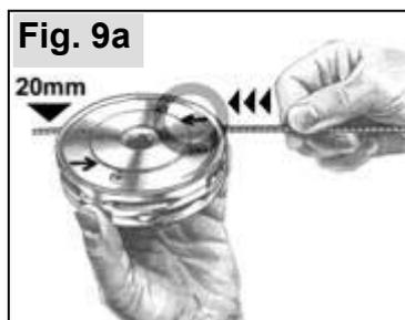
Introduisez les fils de coupe dans le corps de la tête de coupe suivant les flèches sur le corps pour que le fil sorte d'environ 20 mm de l'ouverture opposée.
