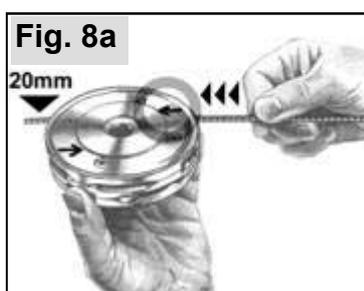
Introducir los hilos de corte en el cuerpo central del cabezal de corte, según las flechas del cuerpo central, de modo que de la abertura del lado opuesto sobresalgan aprox. 20 mm del hilo de corte.
