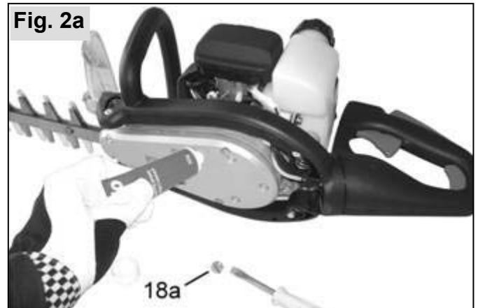
Poser l'appareil sur le côté. Dévisser le bouchon de remplissage (18a) sous le carter et injecter environ 10 à 20 g (environ  $\frac{1}{3}$  du tube de 50 g) dans le réducteur par l'orifice.
