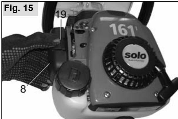
Avant d'ouvrir le filtre à air, fermer le volet de démarrage pour éviter que des impuretés n'entrent dans le carburateur.
