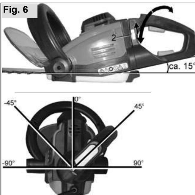
Para colocar el asa trasera en una posición ergonómica óptima, desplace la palanca de bloqueo (2) hacia arriba con el motor apagado para desbloquear y gire el asa trasera hasta la posición deseada. El asa trasera se enclava en cinco posiciones distintas. Procure que el asa quede bien enclavada antes de volver a arrancar. *Consejo: Si el asa no queda bien enclavada la podadora no se encenderá.*
