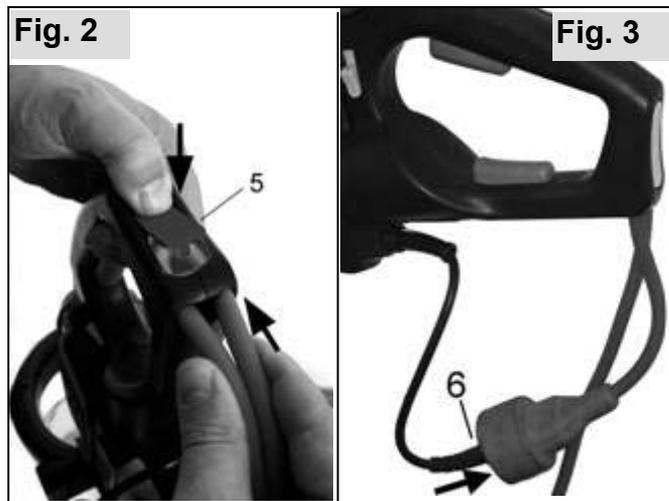
Enganche el cable alargador al dispositivo de descarga de tracción (5) e inserte el enchufe (6) al cable alargador.
