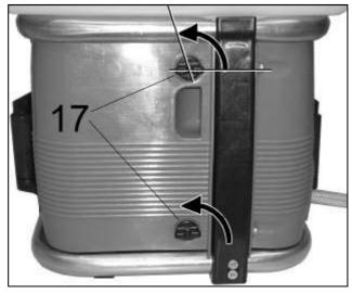
Girare i due pulsanti di chiusura (17) del rivestimento di protezione circa 100° in senso antiorario,
