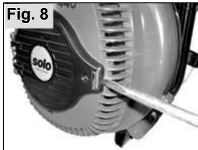
Con ayuda de un destornillador, ejerza presión en el orificio lateral de la tapa del soplador; dicha tapa se desbloqueará.
