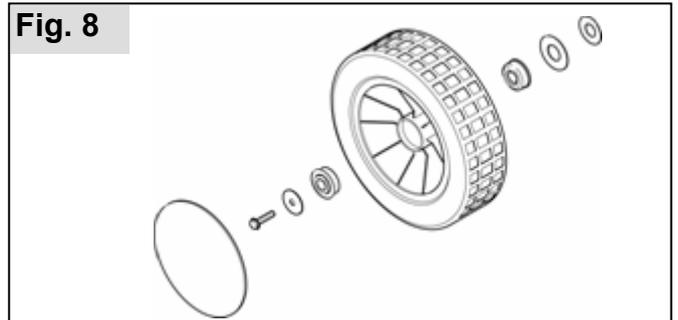
Il doivent être légèrement graissés moins une fois par an. Pour cela, enlevez les chapeaux des roues, desserrez les vis et enlevez les roues. Notez l'ordre de montage des éléments lors du démontage. Nous recommandons la graisse pour roulements SOLO, référence 00 83 175.
