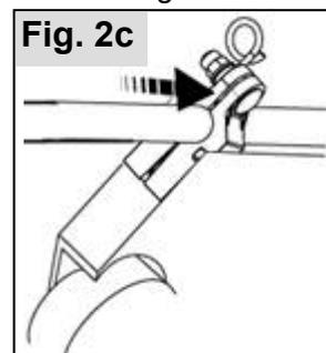
Placez le dispositif de serrage à gauche et à droite dans le chapeau du carter de la tondeuse de façon qu'il affleure et serrez à fond les écrous borgnes.
