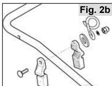
Desserrez les dispositifs de blocage pré montés légèrement en dévissant les écrous borgnes,
