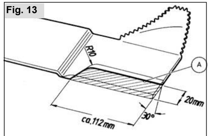
**Remarque :** Les parties tranchantes de la lame peuvent être aiguisées avec une lime en métal. Toutefois, un aiguisage dans un atelier de service après vente agréé est plus recommandé. Les professionnels y veilleront à ce que chaque face de la lame soit limée de la même façon que les autres afin de ne pas provoquer de déséquilibre. L'arête tranchante ne doit être ré aiguisée que jusqu'au repère incrusté.
