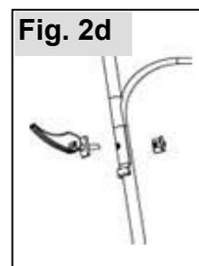
Placez la partie supérieure du guidon sur la partie inférieure de telle façon que les alésages soient l'un en face de l'autre.
