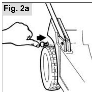
Pour des raisons afférentes au transport, les goujons de support pour la partie inférieure du guidon ne sont pas montés.
