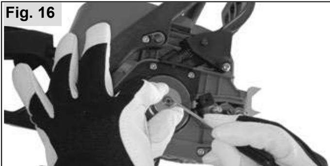
Zum Auswechseln des Kettenrades (nach Demontage der Schienenabdeckung und der Führungsschiene mit der Kette), Kettenrad mit Unterlegscheibe etwas niederdrücken und mit einem kleinen Schraubendreher den Sicherungsring abnehmen.
