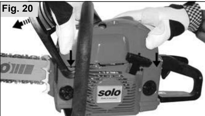
Die Haube leicht zusammendrücken um sie genau in die vordere Nut beim Handschutz an der Starterseite des Grundgehäuses einzupassen. Evtl. den Handschutz bei bereits ausgelöster Kettenbremse in seinem Spiel vorne halten. Vor dem Festziehen der Befestigungsschraube (16) kontrollieren, dass die Haube ringsum komplett in die Nut des Hauptgehäuses eingepasst ist.
