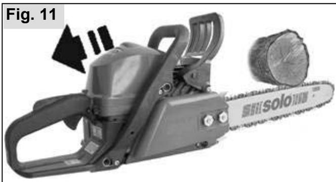
**Gefahr:** Die Motorsäge wird ruckartig in Richtung des Anwenders gestoßen. Durch die große Beschleunigung der Motorsäge und der unkontrollierten Reaktion des Anwenders kann es zu gefährlichen Unfällen kommen.
