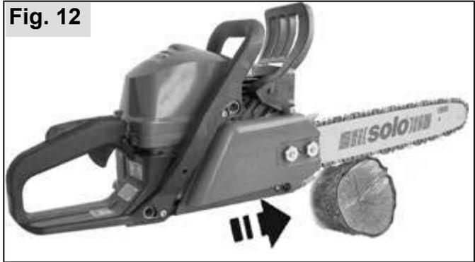
**Sichere Anwendung:** Die Motorsäge wird zum Sägenobjekt gezogen. Durch Ansetzen mit der Anschlagkralle (26a / 26b) des Motorgehäuses am Sägenobjekt kann die Motorsäge nicht weg beschleunigt werden. Das Motorgerät lässt sich sicher vom Anwender führen.
