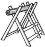
Lose Gegenstände aus Holz müssen sicher befestigt werden, am Besten durch einen Sägebock. Das Holz darf nicht mit dem Fuß oder einer weiteren Person festgehalten werden. Rundhölzer sind gegen Verdrehen im Schnitt zu sichern.
