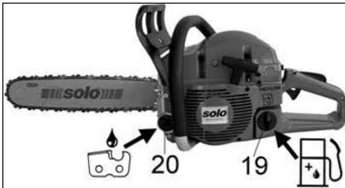
**!** I tappi del serbatoio del carburante e del serbatoio dell'olio di lubrificazione della catena vengono resi stagni tramite l'uso di un O-Ring. Entrambe chiusure devono essere serrate senza l'uso di attrezzi, solo saldamente con le dita.
