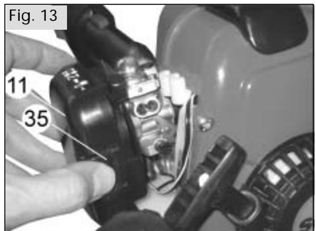
Vor dem Öffnen des Luftfilters die Starterklappe schließen (→), damit kein Schmutz in den Vergaser gelangen kann.
