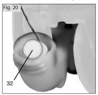
El filtro del combustible lo debe extraer un experto mediante un lazo de alambre con precaución al abrir el depósito de combustible. Hay que tener en cuenta que el espesamiento de la manguera del combustible en la pared del depósito no se puede tirar al depósito.
