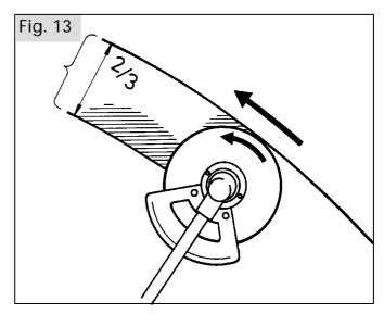
Ataque el material a cortar en punto muerto y acelere al máximo. No deje que el motor esté acelerado demasiado tiempo a menos que la máquina esté cortando.
