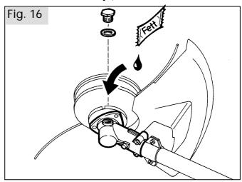
Desenrosque el tornillo lateral. Si en la parte interior del orificio roscado no se aprecia grasa, deberá corregirse el llenado (cantidad de reposición: 5-10 g aprox.).
