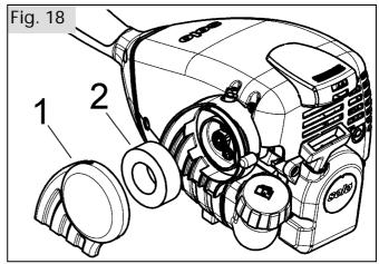
Antes de abrir el filtro del aire cierre la tapa del starter el para que no entre suciedad en el carburador.
