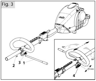
Monte el tope de seguridad (1) en el manillar y asegúrelo con la grapa de fijación (2).
