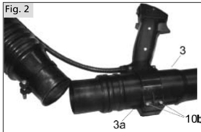
Allentare le due viti inferiori (10b) dell'impugnatura e staccare l'impugnatura dal tubo soffiatore. Inserire la manopola sul tubo irroratore (3) e girare nuovamente le due viti inferiori. Fare attenzione che la manopola possa ancora scorrere sull'aletta guida (3a) del tubo irroratore.
