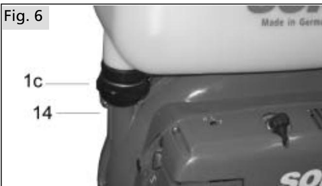
Spingere completamente il contenitore della miscela sul telaio di supporto.
